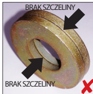
NIE OSADZAĆ SPRĘŻYNY TALERZOWEJ W POKAZANY SPOSÓB
