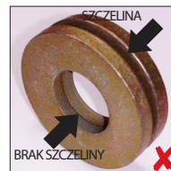
NIE OSADZAĆ SPRĘŻYNY TALERZOWEJ W POKAZANY SPOŚÓB
