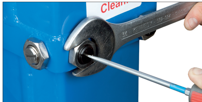
Regulacja śruby ścieralnej masztu
