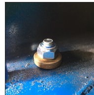
NIE OSADZAĆ SPRĘŻYNY TALERZOWEJ W POKAZANY SPOSÓB
