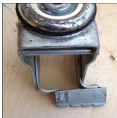
Odkształcenie przycisku nożnego w rezultacie silnego uderzenia od przodu; prawdopodobnie, że odkształceniu uległy także płyta górna i łożysko.
