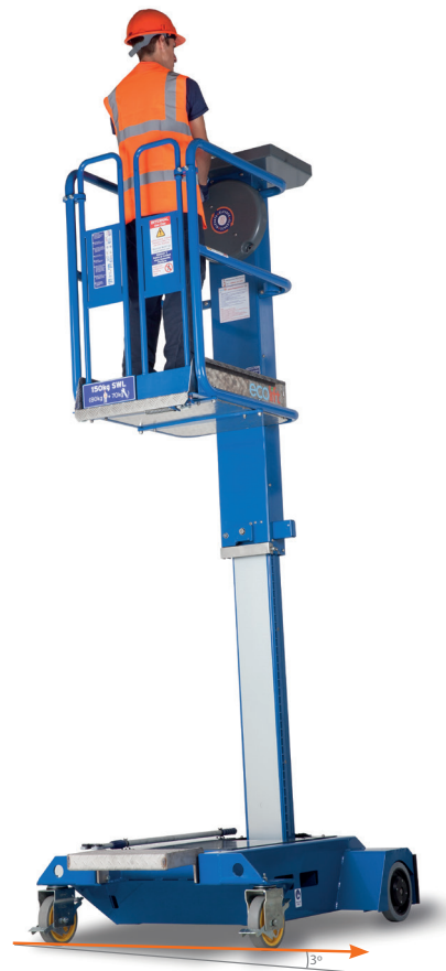
Maszyna przystosowana do pracy na wietrze zachowuje zdolność do pracy przy nachyleniu do wartości 3° i przy wietrze do 12,5 m/s
