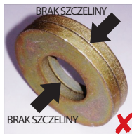
NIE OSADZAĆ SPRĘŻYNY TALERZOWEJ W POKAZANY SPOSÓB
