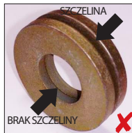
NIE OSADZAĆ SPRĘŻYNY TALERZOWEJ W POKAZANY SPOSÓB
