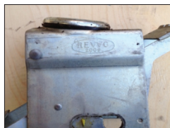
Odkształcenie górnej płyty montażowej w wyniku pojedynczego silnego uderzenia lub kilku uderzeń o słabszym natężeniu. Nawet jeśli pozostałe elementy kółka samoskrętnego są w dobrym stanie technicznym, należy je wymienić.
