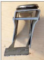
Uderzenie boczne i odkształcenie przycisku nożnego będące następstwem silnego uderzenia bocznego.
